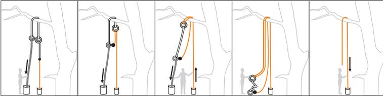
スローバッグ、スローライン、Herbol (P31) を使用して、ロープを下からセッティングすることができます。この事により、作業する方は素早く安全に登ることができます。作業終了後、地上からロープとHerbolを回収することができます。
